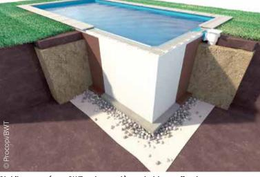
Blokit, proposé par BWT, est un système de bloc coffrant en polystyrène qui permet de réduire la facture énergétique de 23 % en comparaison avec des parois réalisées en parpaings.
